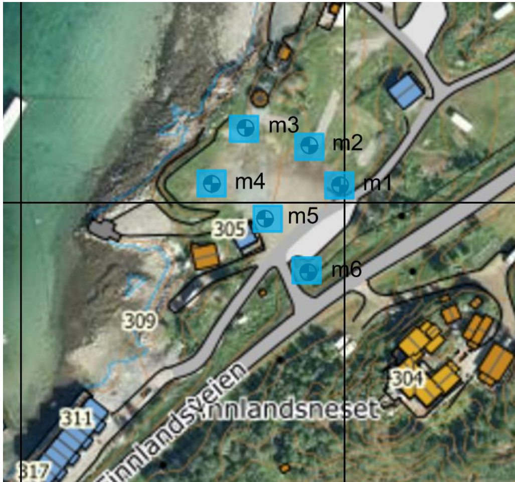
Figur 5-1 Påvist forurensning ved Finnlandsneset i toppjord. Prøvepunktene er markert med farge etter tabell 3-2 i henhold til påvist tilstandsklasse. Kilde: Sweco Norge AS
