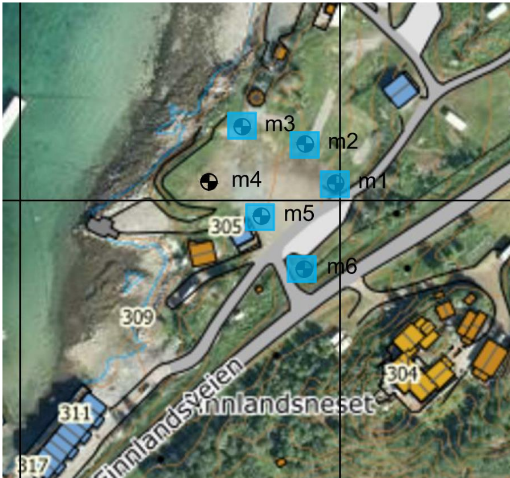
Figur 5-2 Påvist forurensning ved Finnlandsneset i dypere liggende jord. Prøvepunktene er markert med farge etter tabell 3-2 i henhold til påvist tilstandsklasse. Kilde: Sweco Norge AS
