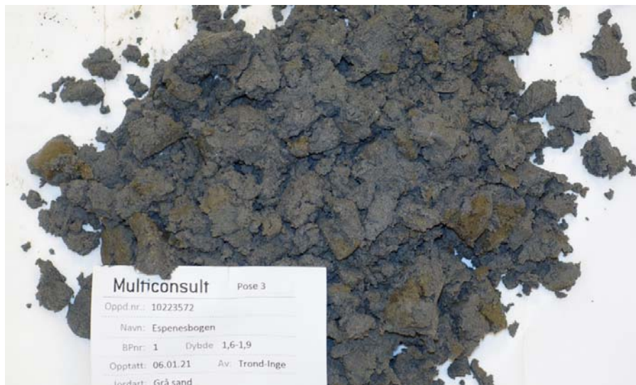
Figur 4-2: Fra prøveserien i borpunkt 1, fra 1,6-1,9 meters dybde.
