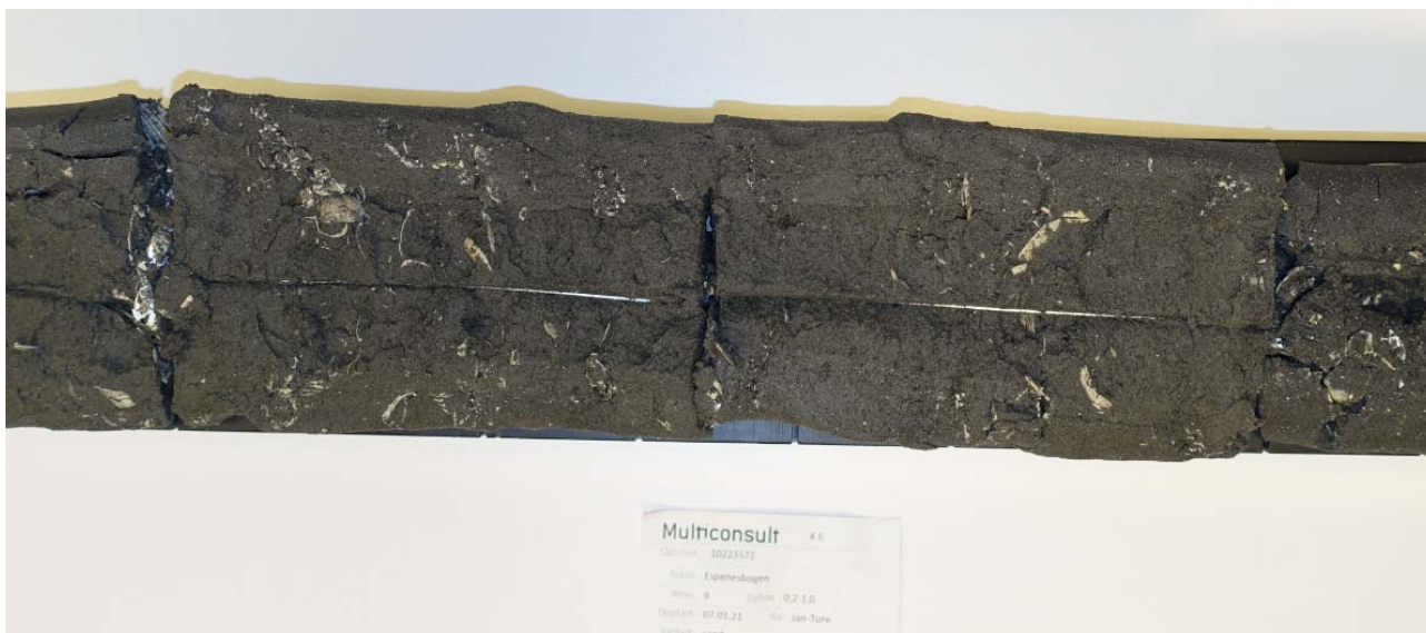
Figur 4-3: Siltig sand fra borpunkt 9, 0,2-1,0 meters dybde. Skjellrester gjennom hele prøven.
