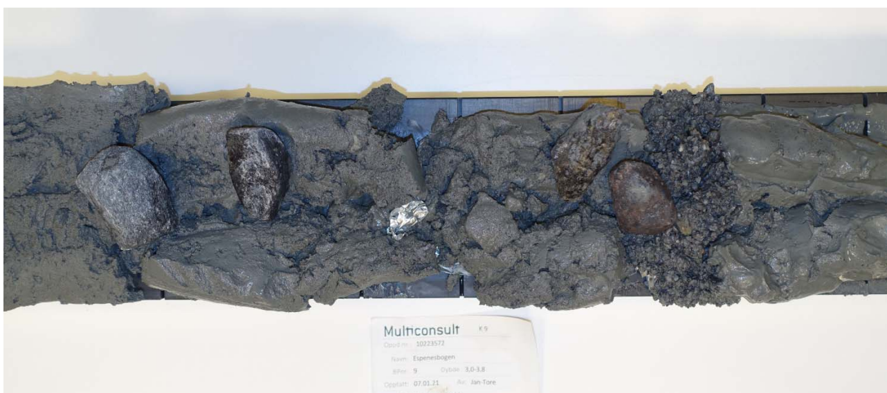
Figur 4-4: Fra borpunkt 9, 3,0-3,8 meters dybde – sandig, grusig, siltig, leirig materiale.
