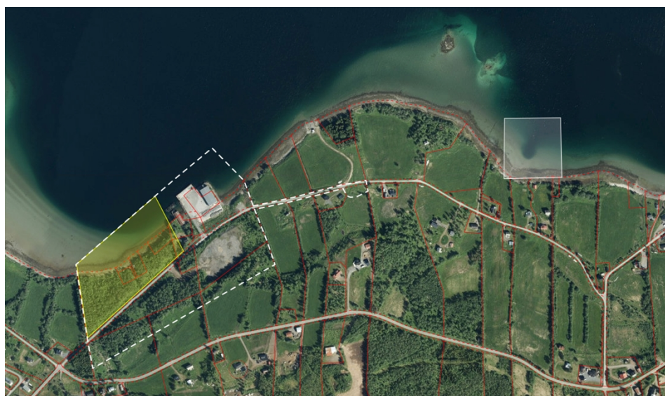
Figur 8: Området som bør undersøkes grundigere før eventuelle terrenginngrep er markert i gult. Innspill ved varsel om oppstart viste at det har gått et lokalt grunnbrudd ved den hvite firkanten på slutten av 1980-tallet.
